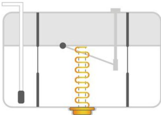
La sonde à ultrasons est collée sous le réservoir : aucun perçage requis. Le réservoir reste intact
