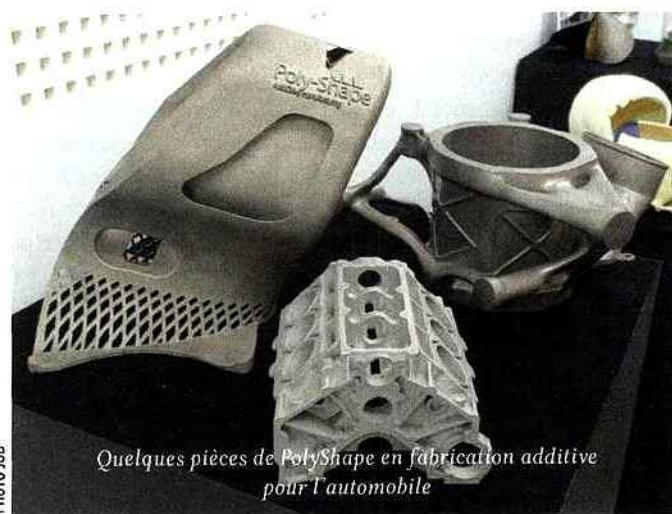
Quelques pièces de PolyShape en fabrication additive pour l'automobile
