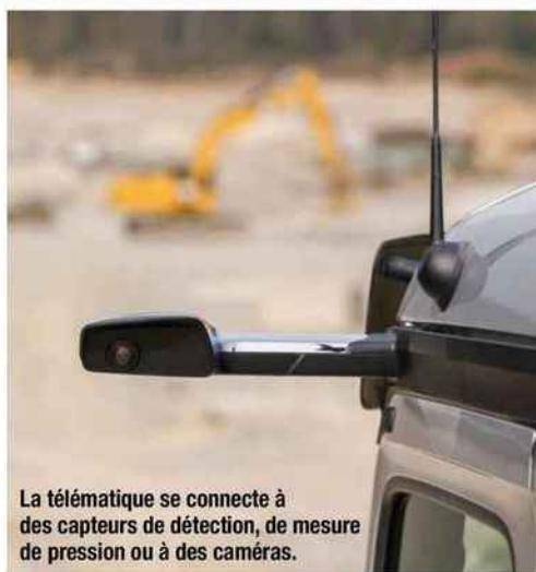
La télématique se connecte à des capteurs de détection, de mesure de pression ou à des caméras.
