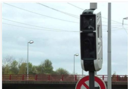
En 2019, plus de **400 radars tourelles seront installés** sur les routes françaises, (plus de 1500 d'ici 2020). Une nouvelle génération de supers-radars sophistiqués capable de scanner sur 8 voies plusieurs types d'infractions (vitesse, distance de sécurité, usage du téléphone au volant) et jusqu'à 32 véhicules simultanément. Inutile de préciser que ça va faire mal.
